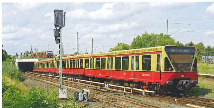
**Bild 2:** Triebzug Baureihe 480 bei Ausfahrt Bornholmer Straße, am Signal neben äußerem Gleis weiß mechanische Fahrsperrung (Foto: DB/Volker Emersleben, 2014).
